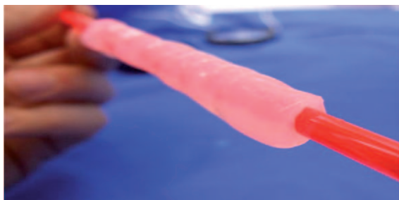
Abbildung 23. Tubuläres Implantat aus bakterieller Nanocellulose, die mithilfe einer Matrixtechnik hergestellt wurde und auf einem roten Glasstab präsentiert wird, der den Blutfluss bei der Verwendung als Gefäßimplantat symbolisiert; Innendurchmesser 6 mm, Länge 15 cm. [182]
